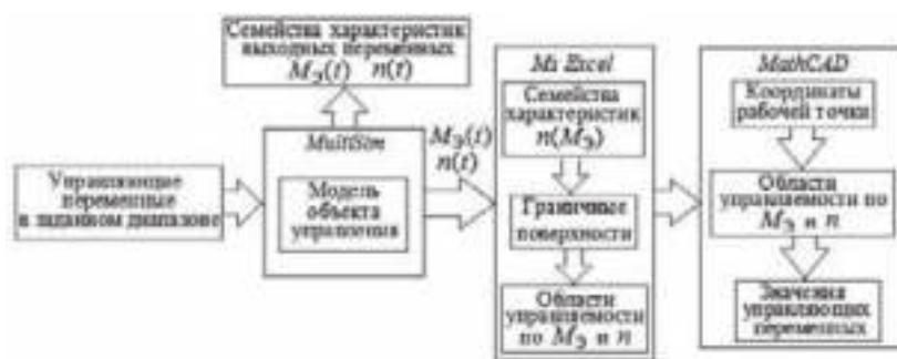
**Рис. 1.** Общая схема решения задачи определения значений вектора управления в области управляемости исполнительного двигателя
